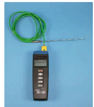
MIN/MAX Thermometer mit zusätzlichem Temperaturfühler
