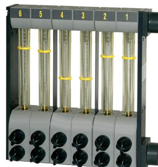
**Durchflußmengenregler mit Schaugläsern aus Kunststoff. Durchflußanzeige durch Schwebekugeln (0 bis 30 l/min). Mit analoger Temperaturanzeige je Regelkreis.**
